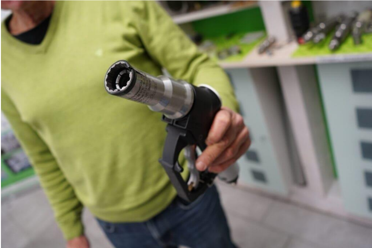
Defekte Füllkupplung aus dem Fundus an Anschauungsobjekten der Apex AG. Quelle: CNGMobility.ch
