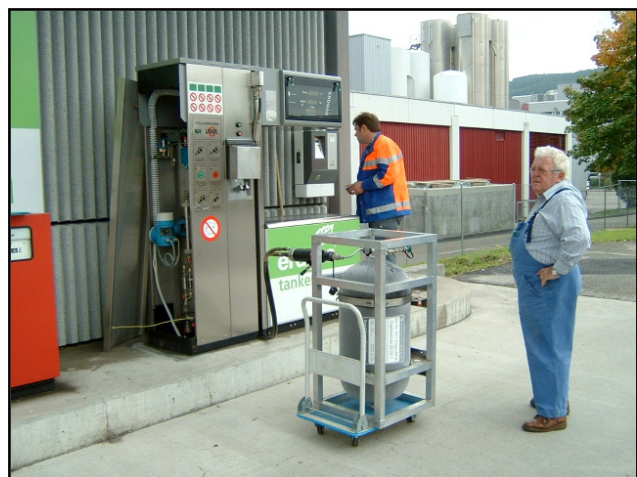
Eichung einer Zapfsäule für Busse
