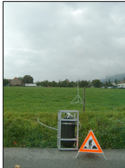
Gasabfackeln, wenn Korrekturarbeiten nötig sind
